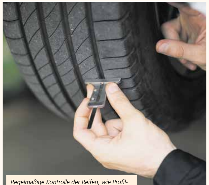
Regelmäßige Kontrolle der Reifen, wie Profiltiefe oder Fülldruck schützt vor unliebsamen Überraschungen. Fotos: AdobeStock
